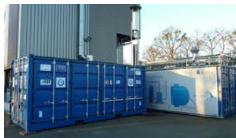
Abb. 1: HELMETH Prototyp bestehend aus Methanisierung li. und Elektrolyse re.
